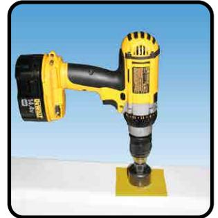
Étape 3 : À l'aide d'une scie-cloche à pointe de diamant de 1/2 po, percez le grand trou. Percez en restant sur la vitesse la plus lente et utilisez de l'huile de graissage ou du savon liquide pour que la scie-cloche reste froide pendant l'opération.
