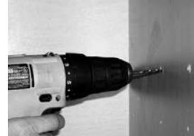
Dans le sachet des pièces, localisez les deux vis autotaraudeuses. Avec une perceuse électrique et un tournevis cruciforme, vissez-les dans le cabinet aux endroits indiqués. Accrochez le système sur les vis, en passant les vis dans les trous de montage du support.
