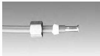
Paso 5 - Asegure el tubo azul a la válvula de cierre de agua fría utilizando la tuerca de bronce. Ajuste con una llave inglesa.
