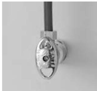
Paso 4 - Ubique el tubo azul de 3/8" dentro de la bolsa de piezas. Extraiga de la bolsa de piezas una tuerca de bronce, un manguito Delrin de plástico y un inserto de bronce. Realice el montaje colocando sobre el tubo azul en primer lugar la tuerca de bronce (extremo abierto afuera), a continuación, el manguito y después introduzca a presión el inserto de bronce hasta el final del tubo. (vea la imagen).
