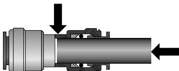
Tirez le tube pour vérifier qu'il est bien coincé. Le système doit être testé avant de quitter le site et/ou avant qu'il soit utilisé.
