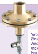
Verbindungskapsel zur elektrohydraulischen Steuerung des Regelventils C 101. Zum Anschluss an den Steuerpiloten des Regelventils und elektrohydraulischen Veränderung der Regeleinrichtung (beispielsweise zur Senkung des Nachdrucks in Nachtphasen und Steigerung des Nachdrucks bei Spitzenabnahmezeiten). Die elektronische Steuerung ist nicht im Lieferumfang enthalten
