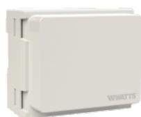
Trasformatore per l'alimentazione 24VAC dei moduli di collegamento WFC-03 6Z NC/NO o WFC-03 8Z NC/NO. Tensione di funzionamento 230 V, tensione di uscita 24 V, potenza di uscita 60VA, classe di protezione IP 30. Cavo di alimentazione 1,5 m con spina Euro (CEE 7/16 EN 50075). Linea di alimentazione al modulo di controllo con spina a 4 poli per una facile combinazione. Per collegare un massimo di 18 attuatori 24 VAC/2,5 W.
