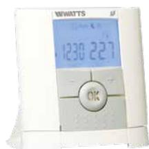
Cronotermostato ambiente digitale a radio frequenza (868MHz) con display LCD per il controllo di diverse tipologie di sistemi di riscaldamento e raffrescamento\*\*. La regolazione è controllata da un sensore interno. Un sensore esterno (PPELE06019) può essere collegato senza ulteriore alimentazione esterna. Un LED rosso indica il funzionamento del riscaldamento.
