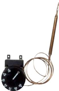
Termostato di regolazione a capillare con 2 contatti in scambio. Capillare in rame L= 900 mm (bulbo 100 mm x Ø 6). Campo di regolazione: 30÷90°C. Portata contatti 16 (5) A-230 V.
