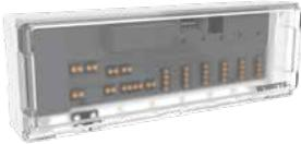
Modulo per il collegamento dei termostati wireless e gestione degli attuatori, di tipo normalmente chiusi (NC) o normalmente aperti (NA). Funzione di riscaldamento e raffreddamento. Antenna radio integrata, antenna esterna per una migliore ricezione (opzionale) per moduli installati all'interno di cassette metalliche, scarsa copertura RF, ecc.
