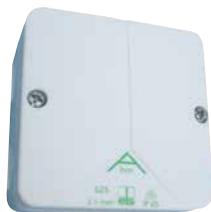
Sensore di temperatura esterna wireless per centraline climatiche Serie RCL-HC. Temperatura ambiente: -10÷55°C. Classe di protezione IP 45. Alimentazione a batterie 2,5V. Alcaline AAA (LR03): autonomia di 5 anni. Un solo sensore può comunicare con più regolatori contemporaneamente.
