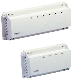
Box modulare di collegamento a 4 o 6 zone. Possibilità di collegare 4/6 termostati. Ogni termostato può comandare fino a 4/6 attuatori. Classe di protezione IP30. Modulo Master con relè di controllo elettropompa. Modulo Slave con connettore plug-in per accoppiamento con unità master.
