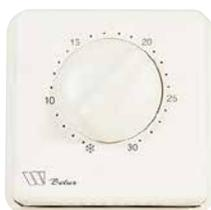
Termostato ambiente con elemento termosensibile a membrana ad espansione di vapore saturo, con 2 contatti in scambio e con spia e interruttore ON/OFF. Membrana in acciaio inox. Dispositivo di blocco temperatura sul retro della manopola. Campo di regolazione: 5÷30°C.
