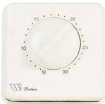
Termostato ambiente con elemento termosensibile a membrana ad espansione di vapore saturo, con 2 contatti in scambio e commutatore Estate/Inverno. Membrana in acciaio inox. Dispositivo di blocco temperatura sul retro della manopola. Campo di regolazione: 5÷30°C.
