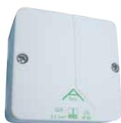
Sensore di temperatura esterna compatibile con unità centrale Serie BT-CT02 o BT-CT03 RF. Munito di cassetta di protezione e batteria interna, 1 Lithium AA battery (LR06) 2600mAh, 10 anni di vita. Classe di protezione IP65. Temperatura di esercizio: -20÷55°C. Campo di regolazione: 180mt (in campo aperto). Distanza di comunicazione RF approssimativa 30m in ambiente residenziale.
