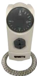
Termostato a contatto di ingombro limitato con molla per fissaggio a tubi fino a 2". Campo di regolazione: 30÷90°C. Differenziale a 20°C<10 K. Portata contatti: 16 (4) A/230 V. Molla: L= 230 mm.
