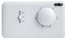
Termostato meccanico per fan coil a 4 tubi. Interruttore ON/OFF (esclusione termostato). Selettore 3 velocità del ventilatore. Dispositivo di blocco temperatura sul retro della manopola.
