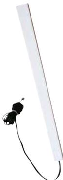
Antenna per centraline climatiche Serie RCL-HC per la ricezione dei segnali in radiofrequenza 868 Mhz. Consente di connettere alle centraline RCL il termo-igrostatato, BT-D03 RF RH, il sensore di temperatura esterna BT-OS03RF e tutti i termostati ambiente con radiofrequenza 868 MHz Watts. Lunghezza cavo 3m, dimensioni 25x195x9,5mm, base adesiva.
