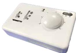
Termostato elettronico per fan coil a 4 tubi. Interruttore ON/OFF (esclusione termostato). Selettore 3 velocità del ventilatore. Commutatore Estate/Inverno. Campo di regolazione: 5÷35°C. Differenziale di temperatura: 0.2°C. Potenza dei contatti: 6(2) A/250V. Regolazione zona morta: 1÷10°C.
