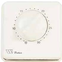
Termostato ambiente con elemento termosensibile a membrana ad espansione di vapore saturo, con 2 contatti in scambio. Membrana in acciaio inox. Dispositivo di blocco temperatura sul retro della manopola. Campo di regolazione: 5÷30°C.
