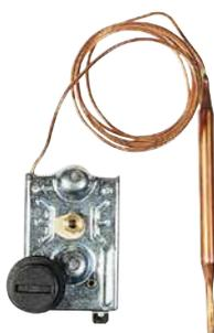
Termostato di blocco a capillare con riarmo manuale. Temperatura di taratura: 97°C±3°C. Capillare in rame L= 900 mm (bulbo 100 mm x Ø 6). Portata contatti: 16 (5) A-230 V.
