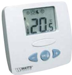
Termostato ambiente elettronico digitale. Modalità di riduzione notturna, switch di selezione livello temperatura (comfort-riduzione) e segnale da interruttore con orologio. Collegabile direttamente ad attuatori elettrotermici Serie 22C, 22CX NA o NC, 22CX5 oppure mediante i moduli WFHC. Visualizzazione su display della temperatura ambiente e modalità di funzionamento. Classe di protezione IP30. Campo di regolazione temperatura: 5÷30°C.
