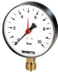
Manometro DN 100 ad attacco radiale, cassa in plastica e indice rosso per impianti di riscaldamento. Campo di misura da 0÷1 a 0÷40 bar. Classe di precisione 1,6. Altre scale ed attacchi a richiesta.
