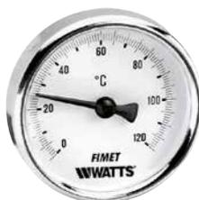
Termometro bimetallico DN 40 ad attacco posteriore con cassa in acciaio zincato e anello cromato per impianti di riscaldamento, completo di pozzetto in ottone, con vite di fissaggio. Classe di precisione 2.
