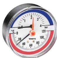
Termomanometro DN 63 ad attacco posteriore, cassa in plastica e indice rosso per impianti di riscaldamento. Classe di precisione della pressione 2,5 - Classe di precisione della temperatura 2.
