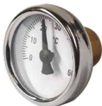
Termometro bimetallico DN 40 con anello cromato ad attacco posteriore con cassa in acciaio zincato per impianti di riscaldamento a pavimento. Classe di precisione 2.
