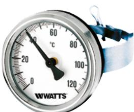
Termometro bimetallico a contatto DN 63, con cassa in acciaio verniciato e fascetta di fissaggio in acciaio per tubazioni da Ø 30 mm a Ø 76 mm. Classe di precisione 2.
