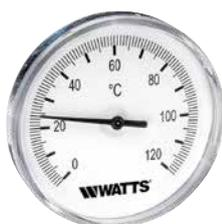
Termometro bimetallico DN 63 ad attacco posteriore con cassa in acciaio zincato per impianti di riscaldamento, completo di pozzetto in ottone, con vite di fissaggio. Classe di precisione 2.
