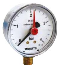
Manometro DN 63 ad attacco radiale, cassa in **acciaio cromato** e indice rosso per impianti di riscaldamento. Campo di misura da 0÷4 a 0÷16 bar. Classe di precisione 1,6. Altre scale e attacchi a richiesta.
