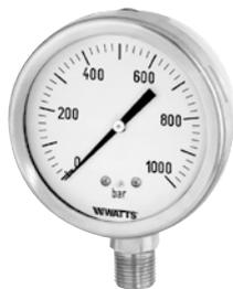
Manometri a molla tubolare Bourdon tutto inox Serie MXG1 per applicazioni industriali speciali, industria chimica, alimentare e navale. Tutto inox a bagno di glicerina DN 100 mm, attacco radiale. Campo di misura da vuoto -1/0 ad alta pressione fino a 1600 bar. Limiti di temperatura fluido: +100°C. Classe di Precisione 1.0 (DN 100).
