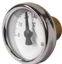
Termometro bimetallico DN 33 con anello cromato ad attacco posteriore con cassa in acciaio zincato per impianti di riscaldamento a pavimento. Classe di precisione 2.
