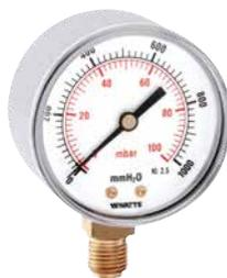
Manometro a membrana DN 63 ad attacco radiale, cassa in acciaio cromato per gas. Campo di misura da 0÷60 a 0÷600 mbar, doppia scala mbar e mmH<sub>2</sub>O. Classe di precisione 2,5.
