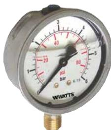
Manometro a bagno di glicerina DN 63 ad attacco radiale con cassa in acciaio inox, per applicazioni industriali. Campo di misura da 0÷1 a 0÷600 bar e doppia scala bar/psi. Classe di precisione 1,6. Altre scale e attacchi a richiesta.
