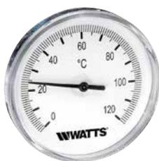
Termometro bimetallico DN 80 ad attacco posteriore con cassa in acciaio zincato per impianti di riscaldamento, completo di pozzetto in ottone, con vite di fissaggio. Classe di precisione 2.
