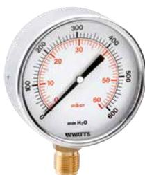
Manometro a membrana DN 100 ad attacco radiale, cassa in acciaio cromato per gas. Campo di misura da 0÷60 a 0÷600 mbar, doppia scala mbar e mm H<sub>2</sub>O. Classe di precisione 2,5. **Conforme a norma EN 837-1.**
