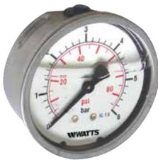
Manometro a bagno di glicerina DN 63 ad attacco posteriore con cassa in acciaio inox, per applicazioni industriali. Campo di misura da 0÷1 a 0÷600 bar e doppia scala bar/psi.
