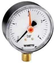
Manometro DN 80 ad attacco radiale, cassa in plastica e indice rosso per impianti di riscaldamento. Campo di misura da 0÷1 a 0÷40 bar o 0÷60 mH<sub>2</sub>O. Classe di precisione 1,6. Altre scale e attacchi a richiesta.
