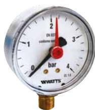
Manometro DN 80 ad attacco radiale, cassa in **acciaio cromato** e indice rosso per impianti di riscaldamento. Campo di misura da 0÷4 a 0÷16 bar. Classe di precisione 1,6. Altre scale e attacchi a richiesta.
