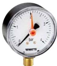
Manometro DN 63 ad attacco radiale, cassa in plastica e indice rosso per impianti di riscaldamento. Campo di misura da 0÷1 a 0÷40 bar. Classe di precisione 2,5. Altre scale ed attacchi a richiesta. **Conforme a norma EN 837-1 e ai requisiti tecnici INAIL.**
