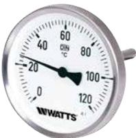
Termometro bimetallico DN63 ad attacco posteriore, con cassa e stelo in acciaio inox, per impianti industriali. Campo di misura da 0-60 a 160°C / -20+60°C. Lunghezze stelo 63-100-150mm, senza pozzetto. Classe di precisione 1 conforme DIN16203. **Conforme a norma EN 60529.**
