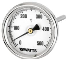
Termometro bimetallico DN 63 ad attacco posteriore con cassa in acciaio zincato ed anello cromato per la misura della temperatura dei fumi (pirometro). Campo di misura 0÷500°C. Classe di precisione 2.
