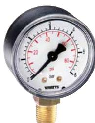
Manometro DN 80 ad attacco radiale, cassa in plastica e per applicazioni industriali. Campo di misura da 0÷10 a 0÷25 bar e doppia scala bar/psi. Classe di precisione 1,6. Altre scale e attacchi a richiesta.
