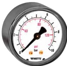
Manometro DN 50 ad attacco posteriore, cassa in plastica per applicazioni industriali. Campo di misura da 0÷1 a 0÷20 bar doppia scala bar/psi. Classe di precisione 2,5. Altre scale e attacchi a richiesta.
