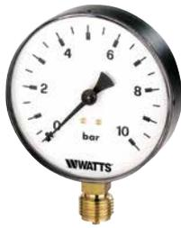
Manometro DN 100 ad attacco radiale, cassa in plastica e per applicazioni industriali. Campo di misura da 0÷2,5 a 0÷40 bar e doppia scala bar/psi. Classe di precisione 1,6. Altre scale e attacchi a richiesta.
