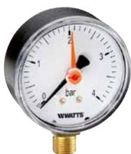
Manometro DN 50 ad attacco radiale, cassa in plastica e indice rosso per impianti di riscaldamento. Campo di misura da 0÷4 a 0÷40 bar. Classe di precisione 2,5. Altre scale ed attacchi a richiesta. **Conforme a norma EN 837-1 e ai requisiti tecnici INAIL.**
