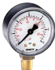
Manometro DN 50 ad attacco radiale, cassa in plastica per applicazioni industriali. Campo di misura da 0÷1 a 0÷40 bar e doppia scala bar/psi. Classe di precisione 2,5. Altre scale e attacchi a richiesta.
