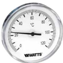
Termometro bimetallico DN 40 ad attacco posteriore con cassa in acciaio zincato per impianti di riscaldamento, completo di pozzetto in ottone, con vite di fissaggio. Classe di precisione 2.
