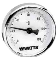
Termometro bimetallico DN 63 ad attacco posteriore con cassa in policarbonato ed anello in acciaio cromato, per impianti di riscaldamento completo di pozzetto in ottone – fissaggio con O-ring. Classe di precisione 2.
