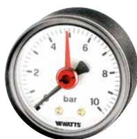
Manometro DN 63 ad attacco posteriore, cassa in plastica e indice rosso per impianti di riscaldamento. Campo di misura da 0÷4 a 0÷40 bar. Classe di precisione 2,5. Altre scale e attacchi a richiesta.
