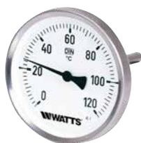
Termometro bimetallico DN80 ad attacco posteriore, con cassa e stelo in acciaio inox, per impianti industriali. Campo di misura da 0-60 a 160°C / -20+60°C. Lunghezze stelo 63-100-150-200mm, senza pozzetto. Classe di precisione 1 conforme DIN16203. **Conforme a norma EN 60529.**
