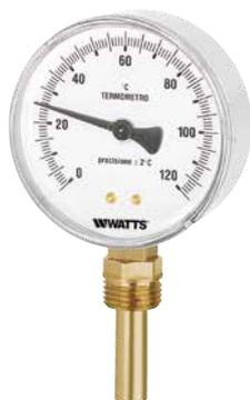
Termometro bimetallico DN 80 ad attacco radiale con cassa in acciaio cromato per impianti di riscaldamento completo di pozzetto in ottone - fissaggio con O-ring. Classe di precisione 2.
