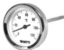
Termometro Bimetallico per centraline solari. Cassa in plastica DN 51 con anello cromato attacco posteriore. Campo di misura da 0-60 a 160 °C . Classe di precisione cl. 2.0.
