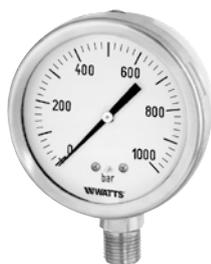
Manometri a molla tubolare Bourdon tutto inox Serie MXG1 per applicazioni industriali speciali, industria chimica, alimentare e navale. Tutto inox a bagno di glicerina DN 63 mm, attacco radiale. Campo di misura da vuoto -1/0 ad alta pressione fino a 1000 bar. Limiti di temperatura fluido: +100°C. Classe di Precisione 1.6.
