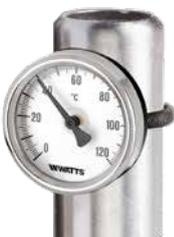
Termometro bimetallico a contatto DN 63, con cassa in acciaio verniciato e molla di fissaggio per tubazioni da Ø 30mm a Ø 65mm. Classe di precisione 2.
