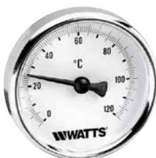
Termometro bimetallico DN 80 ad attacco posteriore con cassa in acciaio zincato ed anello cromato per impianti di riscaldamento completo di pozzetto in ottone, con vite di fissaggio. Classe di precisione 2.
