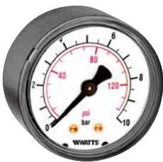
Manometro DN 40 ad attacco posteriore, cassa in plastica per applicazioni industriali. Campo di misura da 0÷1 a 0÷20 bar doppia scala bar/psi. Classe di precisione 2,5. Altre scale e attacchi a richiesta.
