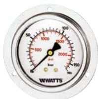
Manometro a bagno di glicerina DN63 ad attacco posteriore per montaggio a pannello con flangia 3 fori per applicazioni industriali. Cassa in acciaio inox e doppia scala bar/psi. Classe di precisione 1,6. Disponibili anche DN 100, per campi di misura da 0÷1 a 0÷600 bar a richiesta.
