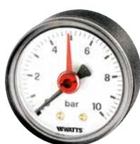
Manometro DN 50 ad attacco posteriore, cassa in plastica e indice rosso per impianti di riscaldamento. Campo di misura da 0÷4 a 0÷40 bar. Classe di precisione 2,5. Altre scale e attacchi a richiesta.
