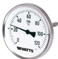
Termometro bimetallico DN100 ad attacco posteriore, con cassa e stelo in acciaio inox, per impianti industriali. Campo di misura da 0-60 a 160°C / -20+60°C. Lunghezze stelo 63-100-150-200mm, senza pozzetto. Classe di precisione 1 conforme DIN16203. **Conforme a norma EN 60529.**
