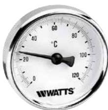
Termometro bimetallico DN 80 ad attacco posteriore con cassa in policarbonato ed anello in acciaio cromato, per impianti di riscaldamento completo di pozzetto in ottone – fissaggio con O-ring. Classe di precisione 2.
