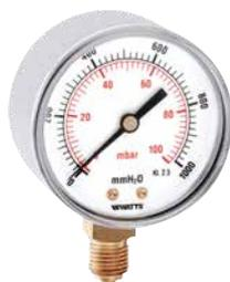
Manometro a membrana DN 80 ad attacco radiale, cassa in acciaio cromato per gas. Campo di misura da 0÷60 a 0÷600 mbar, doppia scala mbar e mm H<sub>2</sub>O. Classe di precisione 2,5. **Conforme a norma EN 837-1.**
