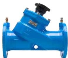
Valvola di taratura e bilanciamento con attacchi flangiati per impianti di riscaldamento e raffreddamento. Funzioni di intercettazione, pretaratura; diagnosi mediante strumento su prese di misura pressione ad autotenuta. PN 16. Flange EN 1092-2. Tenuta sede: EPDM. DN 65÷300. Temperatura di esercizio: -10÷120°C. Corpo valvola in ghisa sferoidale con trattamento superficiale in vernice epossidica. Volantino di taratura in nylon e alluminio.
