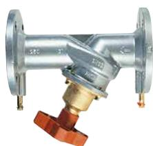
Valvola di taratura e bilanciamento con attacchi flangiati per impianti di riscaldamento e raffreddamento. Funzioni di intercettazione, pretaratura; diagnosi mediante strumento computerizzato (TA-SCOPE, CMI) su prese di misura pressione ad autotenuta. PN 16. Interasse corpo ISO 5752 Serie 1 ed EN 558-1 Serie 1, flange ISO 7005-2, EN 1092-2. Tenuta sede: otturatore con anello EPDM.
