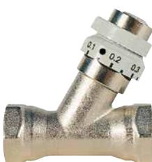
Detentore di intercettazione e taratura adatto per il bilanciamento di unità terminali in impianti di riscaldamento, raffreddamento e in reti di distribuzione dell'acqua ad uso sanitario. Taratura con chiave ad incastro posizionando l'apposito inserto nell'anello con graduazione. PN16. Temperatura di lavoro:  $-10 \div 120^{\circ}\text{C}$ . Corpo, otturatore, stelo e raccordi in AMETAL<sup>®</sup>, trattato superficialmente con nichelatura. O-Ring in gomma nitrilica. Attacchi 1/2" FF.
