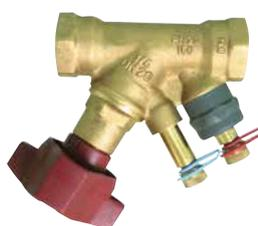
Valvola di taratura e bilanciamento con attacchi filettati per impianti di riscaldamento, raffreddamento, acqua per uso sanitario. Funzioni di intercettazione, pre-taratura con 40 posizioni, scarico (kit accessorio opzionale); diagnosi mediante strumento computerizzato (BVT-SET) su prese di misura pressione ad autotenuta. Corpo valvola in AMETAL® (lega antidezincificazione). Volantino digitale in plastica poliammide. Tenuta sede: otturatore con O-ring in EPDM. PN 20.
