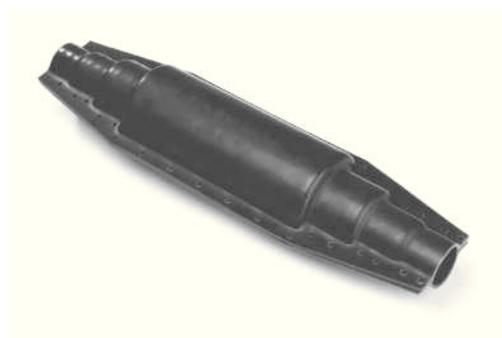
Гарантирует полную изоляцию и уплотнение прямых соединений между трубами UNO, DUO и QUADRO. Комплект состоит из 2 симметричных половинок PE-HD, сегментов теплоизоляции из каменной ваты, комплект резинового уплотнителя на битумной основе, болтов из нержавеющей стали и инструкции по сборке. Термоусадочные колпачки для гидроизоляции торцов трубопроводов заказываются отдельно.
