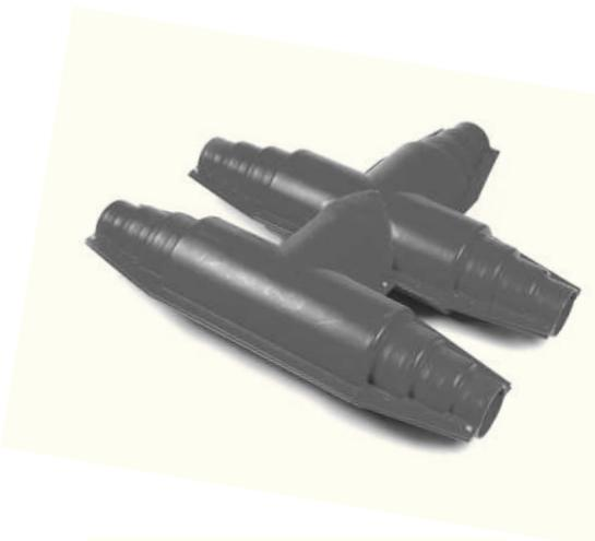
Гарантирует полную теплоизоляцию и герметичность соединений между отводами UNO, DUO и QUADRO труб. Комплект состоит из 2 симметричных половинок PE-HD, сегментов теплоизоляции из каменной ваты, комплект резинового уплотнителя на битумной основе, болтов из нержавеющей стали и инструкции по сборке. Термоусадочные колпачки для гидроизоляции торцов трубопроводов заказываются отдельно.
