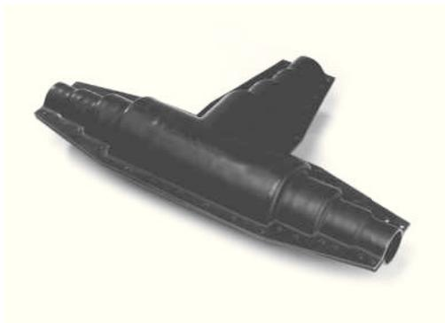
Гарантирует полную теплоизоляцию и герметичность соединений между отводами UNO, DUO и QUADRO труб. Комплект состоит из 2 симметричных половинок PE-HD, сегментов теплоизоляции из каменной ваты, комплект резинового уплотнителя на битумной основе, болтов из нержавеющей стали и инструкции по сборке. Термоусадочные колпачки для гидроизоляции торцов трубопроводов заказываются отдельно.
