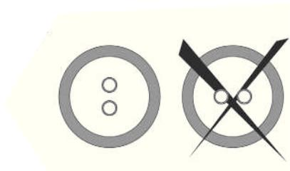
При использовании трубы Микрофлекс DUO с одним из перечисленных выше изоляционных комплектов рекомендуется располагать напорные трубы в вертикальной ориентации. Этот метод делает сборку концевых соединений в корпусе существенно проще.
