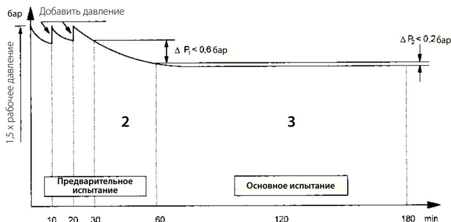
Проверьте готовую трубопроводную систему перед ее засыпкой! Правильное выполнение и документирование теста на герметичность для всей системы трубопроводов является обязательным гарантийным условием.
