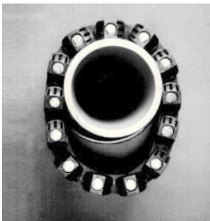
Убедитесь, что головки всех болтов обращены к установщику. Провисание секций уплотнения допустимо. Не удаляйте секции, если вы правильно подобрали необходимый размер для соответствующего кожуха трубы и диаметра отверстия. Примечание: на меньших диаметрах труб, уплотнительные звенья могут быть даже растянуты.
