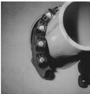
Ослабьте стягивающие болты крепления, чтобы секции уплотнения могли свободно перемещаться. Соедините оба конца уплотнения вокруг трубы.
