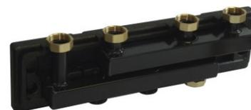
costante la temperatura di mandata del circuito secondario miscelando opportunamente la mandata del circuito primario e il ritorno del circuito secondario. E' particolarmente indicata negli impianti di riscaldamento a pannelli radianti dove è necessario mantenere costante la temperatura del fluido termovettore prima di poter essere inviato ai circuiti radianti.
