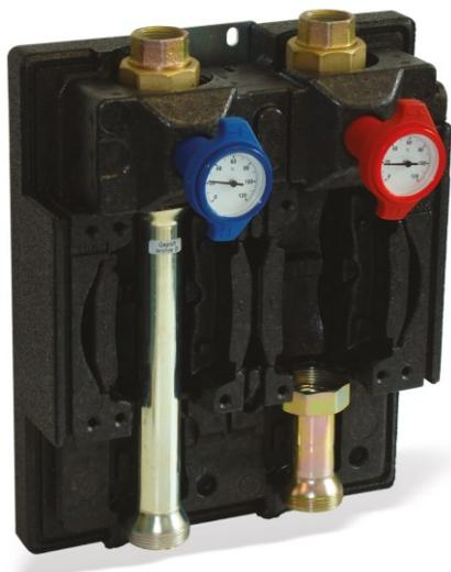
La valvola di intercettazione della mandata è dotata di **sistema gravity flow stop** che impedisce la circolazione naturale a pompa ferma. Questo permette di inserire le unità terminali del circuito secondario, senza necessità di un'ulteriore regolazione di temperatura, integrando perfettamente i **Collettori VB32**.
